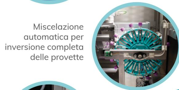
Miscelazione automatica per inversione completa delle provette
